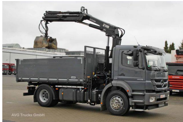
Bild: Beispiel für einen möglichen Fahrzeugtyp mit integriertem Kran und Greifer
