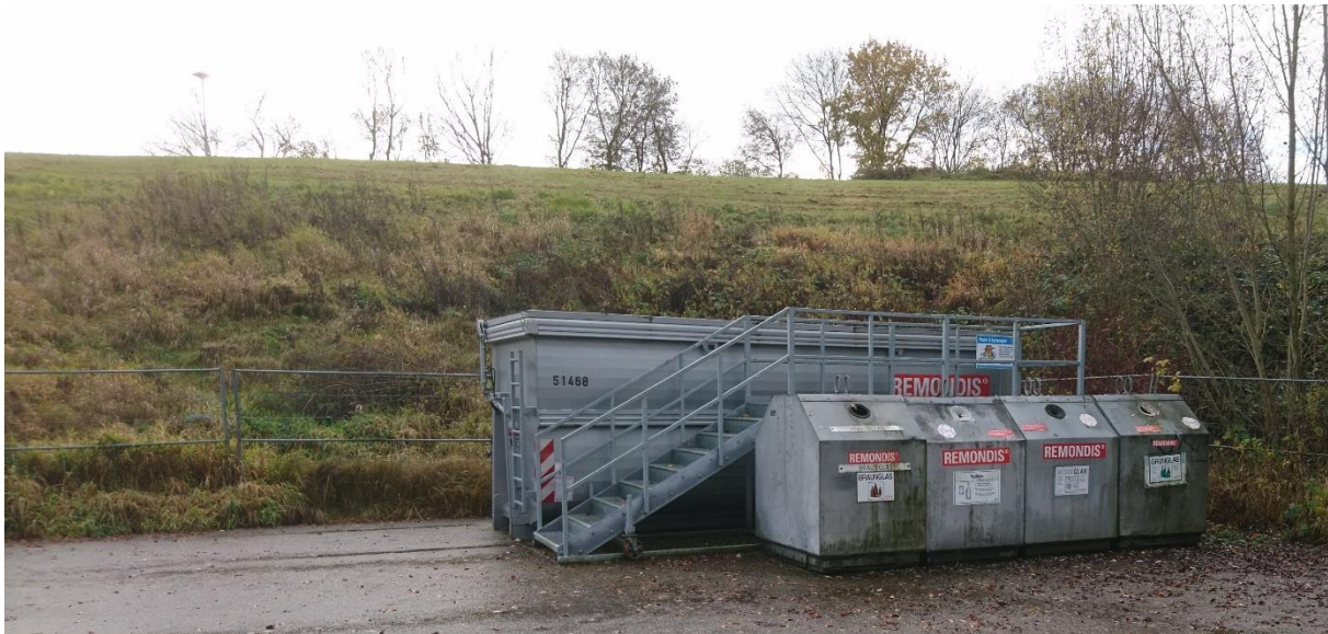
Bild: Abrollcontainer mit Aufstiegshilfe
