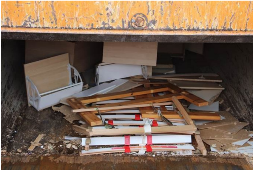
Bild 01: Typisches A IV-Holz mit hohen Kunststoffanteilen in der Erfassung zusammen mit Sperrmüll (Bild: Press-container A IV bei AWM)
