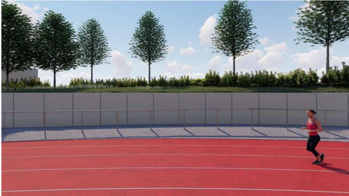
Für die Erstellung der neuen Stützwand eignen sich Betonfertigteile in Form von L-Steinen, die zur Baustelle transportiert und elementweise eingehoben werden können. Die Elementbreiten betragen jeweils ca. 1,50m.
